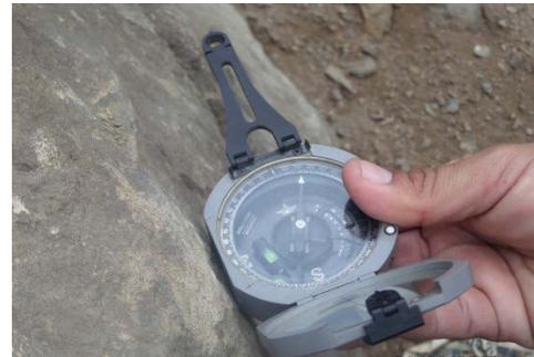
**Figura 9:** Medición de buzamiento y dirección de buzamiento
