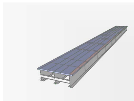
Figura 10 – Modelo Tridimensional en SAP 2000
