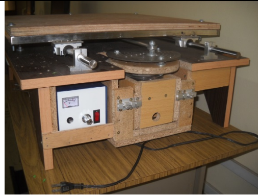
Foto 6: vista frontal de la mesa. Obsérvese a la izquierda voltímetro controlador de la velocidad.
