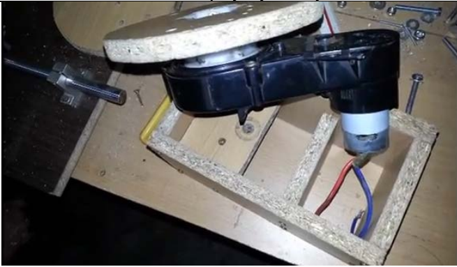
Foto 3: vista del motor para la mesa vibradora.
