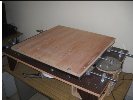
Foto 8: Vista final de la mesa vibradora.
