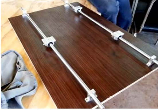
Foto 1: Tablero de apoyo de la mesa vibradora. Obsérvese barras de apoyo y rodajes lineales.
